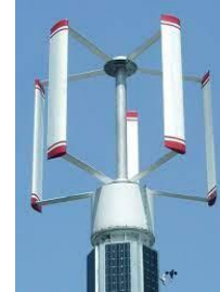
垂直軸發電機
